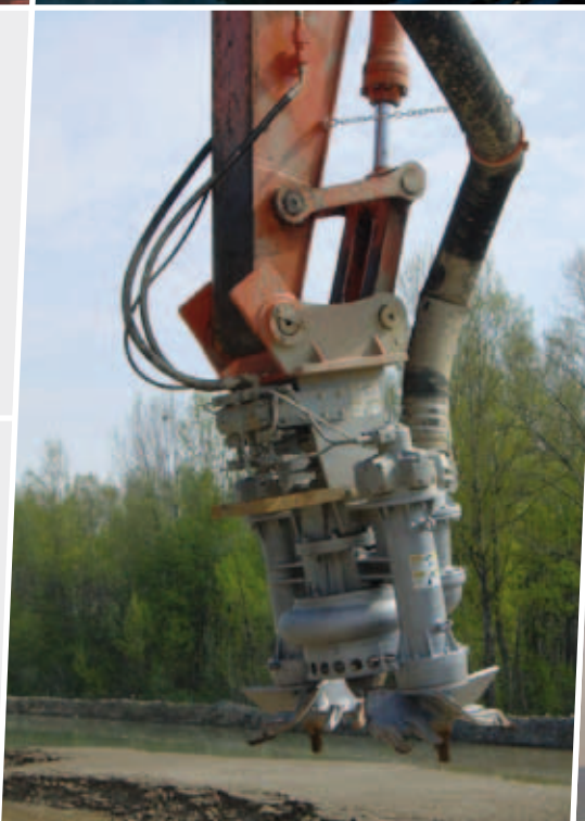
Pompes Dragflow actionnées par engins hydrauliques
