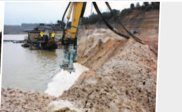
Unité de dragage complète pour extraction de sable - Royaume-Uni
