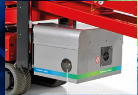
Le chargeur des batteries indique l'état de la recharge.
