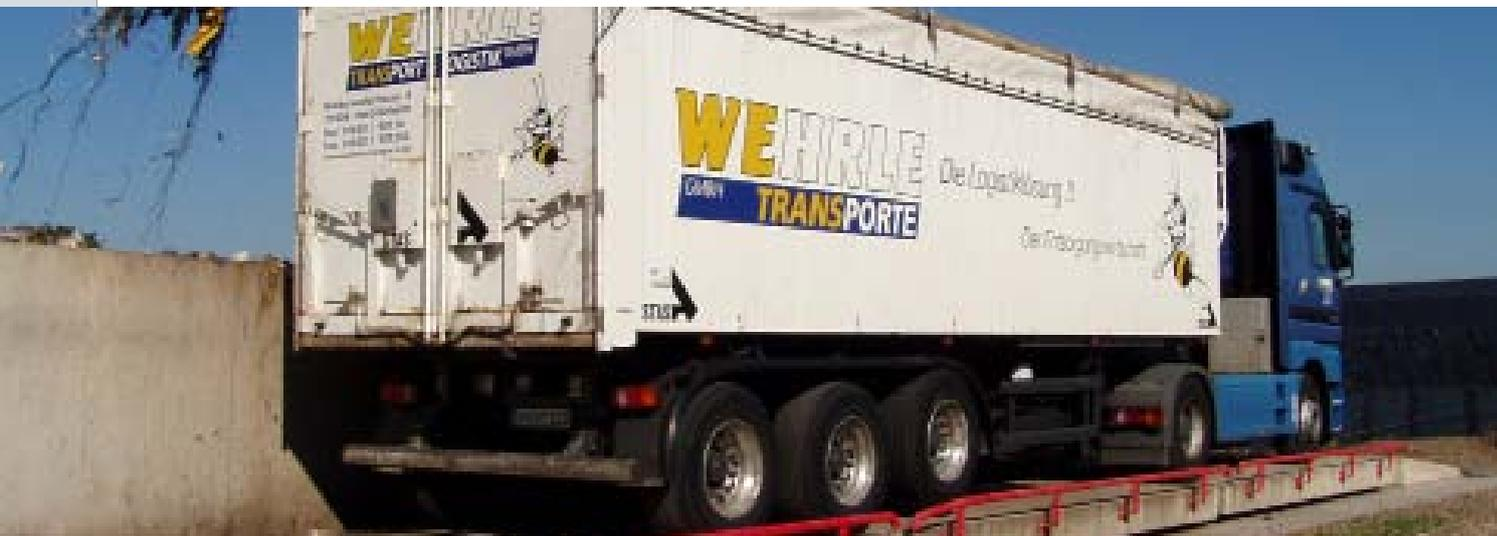
Pont-bascule mobile de béton précontraint qui nécessite seulement un montage au sol simple. Il est suffisament de placer les dalles de béton, de placer les rampes et de calibrer les balances pour fonctionner.
