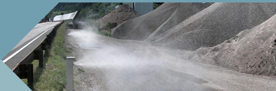
Version **RFX-Road** pour la construction le long des routes à éviter poussière ennuyeuse. Automatique avec un détecteur de mouvement ou en utilisation continu.
