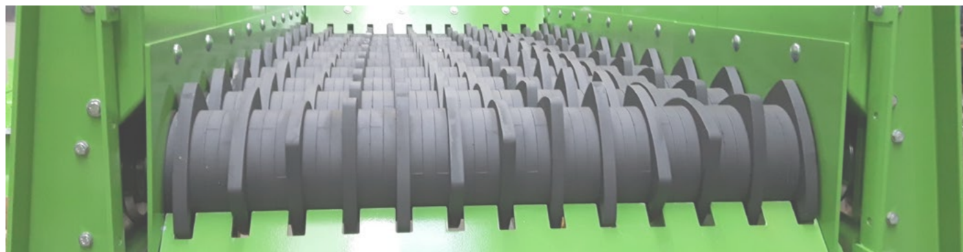
Die Größe des Siebkastens mit den Innenmaßen von 1.200 x 3.500 mm Siebfläche, ist für die Leistung von 400 t/Stunde und einer Absiebung von 0 - 80 mm im Feinkorn ausgelegt
