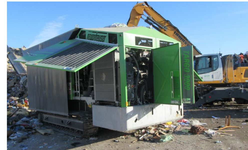
Die neu gestalteten Motorraumtüren ermöglichen einen noch bequemeren Zugang für die täglichen Wartungs- und Servicearbeiten.
