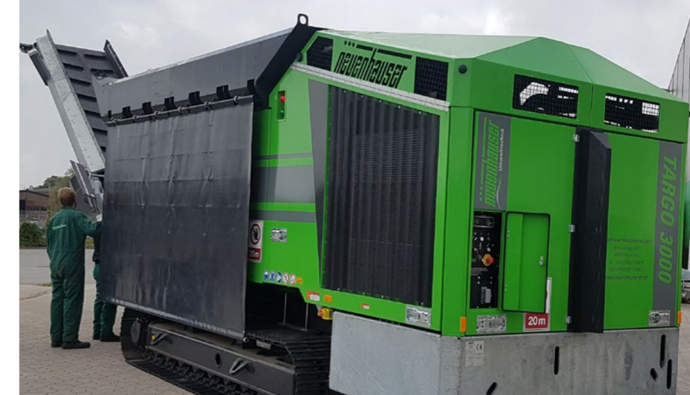
Seitlich am Aufgabetrichter sind die Schutzplanen angebracht. Hinter dem feuerverzinkten Anfahrerschutz befinden sich die Diesel- und Hydrauliköltanks.
