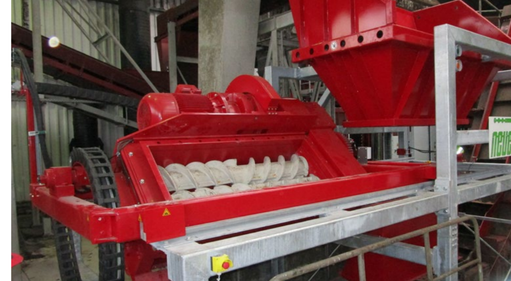
Der Mühlenkorpus kann einfach über einen kleinen Elektromotor in die Serviceposition verfahren werden. Einmal dort angekommen, lässt sich der gesamte Korpus um 180° drehen. Eine bessere Zugänglichkeit ist kaum möglich und erleichtert den Maschinenbedienern die Arbeit.
