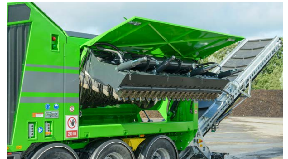
Da geht jedem Maschinenbediener das Herz auf: Durch das Öffnen des Gegenkamms lassen sich die schraubbaren Werkzeuge sicher und einfach vom Boden aus wechseln und weitere Wartungsarbeiten durchführen.
