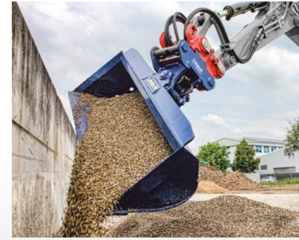
Symlock-Adapter macht z. B. aus Grabenräumlöffeln eine Seitenkippschaufel
