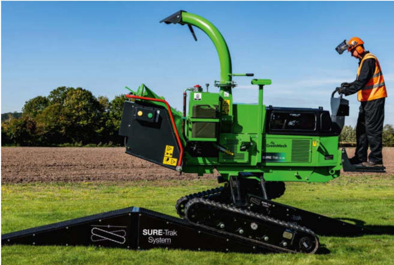
Obwohl der GreenMech SAFE-Trak 19-28 in erfahrenen Händen schon sehr sicher ist, gibt es aber dennoch einige Bodenunebenheiten, die dem Bediener Unbehagen bereiten können. Zum Beispiel ein abruptes Kippen des Raupenhäckslers („Baggerkippmoment“) bei unterschiedlichen Geländesituationen auf jeder Kettenseite.
