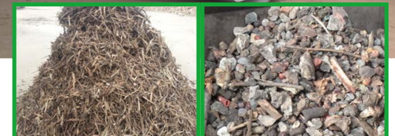
Materialbeispiele: Steinfreie Biomasse 30-150 mm (links). Beispiel einer Schwerfraktion (rechts).
