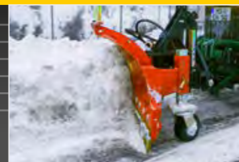
Lame de déneigement d'une épaisseur de 5 ou 6 mm
