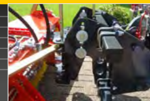
Montage pour grue agricole avec compensation de niveau 3D
