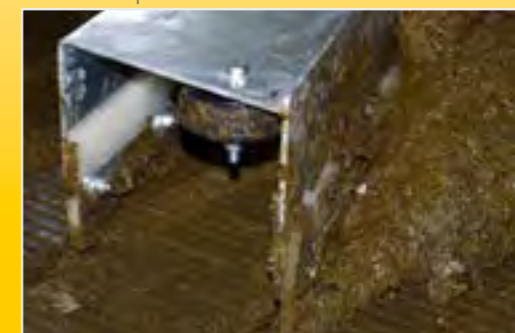
Racloir à double lame avec rouleau d'espacement
