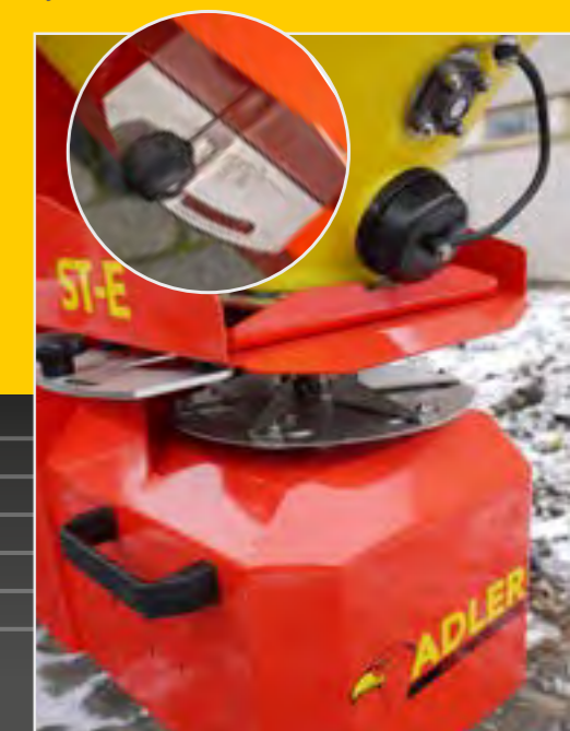
Des largeurs d'épandage de jusqu'à 8 m, réglables par le nombre de tours et le dosage. Détail : Dispositif de dosage et le réglage de la quantité de sel
