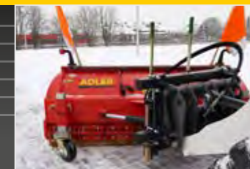
Système de montage universel avec mécanisme de rotation hydraulique (avec deux cylindres hydrauliques)
