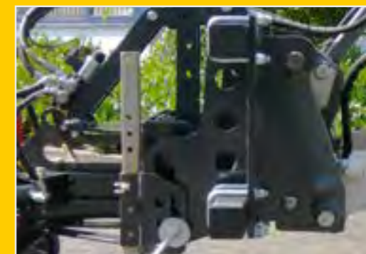
Fixation à la grue agricole avec compensation de niveau et béquille de support.
