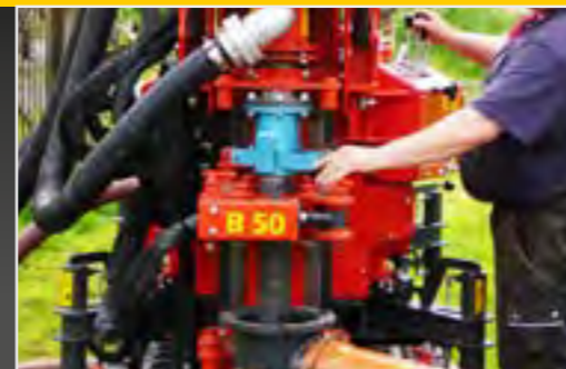
Dispositif de bris en interaction avec la pince hydraulique – disponible en série chez tous les modèles de la série B.
