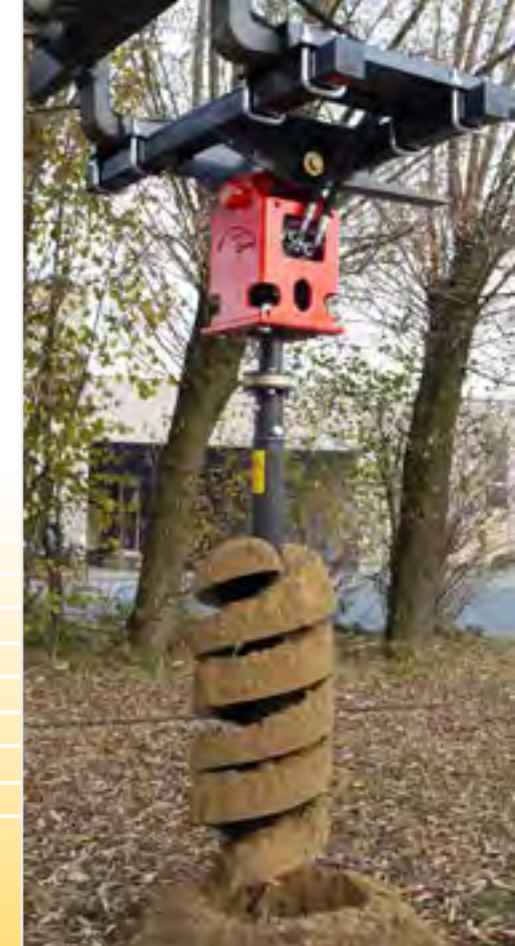
Tarière en fonctionnement dans la terre
