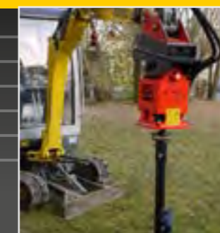
Tarière sur un mini-excavateur
