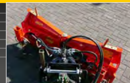
Fixation à la grue agricole avec compensation de niveau et béquille de support.
