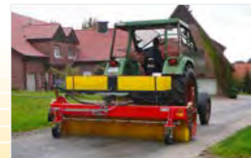
K 600 avec le mode de déblaiement simple (élévation hydraulique du conteneur) et la protection de surcharge moteur
