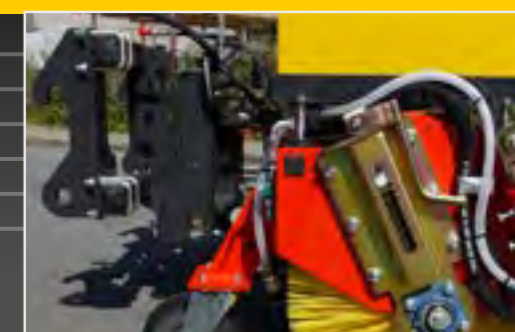
Installations pour chargeuse sur pneus avec compensation de niveau à travers de conduite par roulettes
