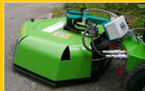
Heißlufteinheit mit elektrischer Steuerung und hydraulischen Anschlüssen
