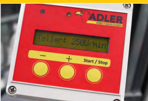
Drehgeschwindigkeit frei einstellbar
