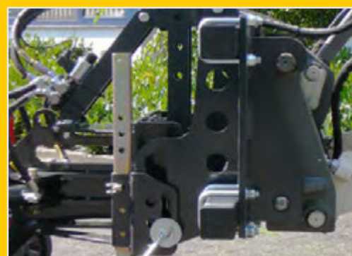
Hofladeraufnahme mit Niveaueingleich und Abstellstütze
