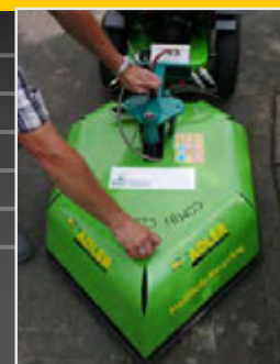
Seitenverstellung um 45° (vom Mittelpunkt aus) – damit erreichen Sie selbst schwer zugängliche Bereiche
