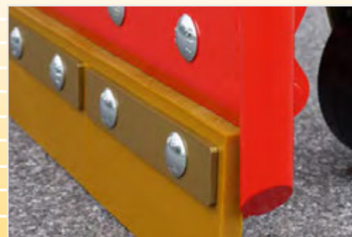
Vereisungsfreie Federklappen, serienmäßig mit Randabweiser
