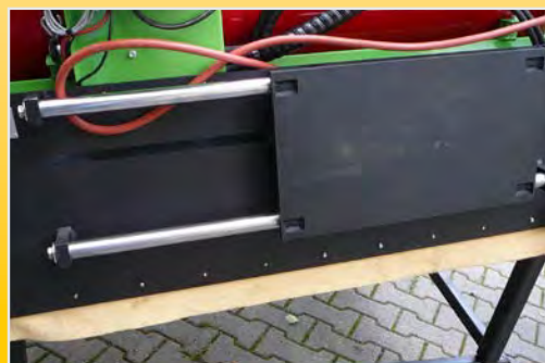
Hydraulische Seitenverschiebung um 35 cm
