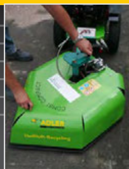
Seitenverstellung um 45° (vom Mittelpunkt aus) – damit erreichen Sie selbst schwer zugängliche Bereiche
