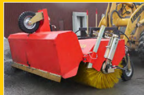
Freikehrmodus und 750 mm Bürstendurchmesser serienmäßig
