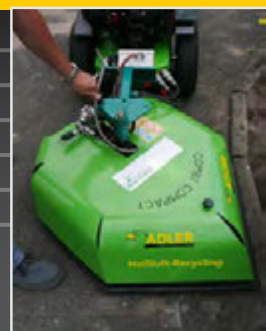
Heißlufteinheit mit elektrischer Steuerung und hydraulischen Anschlüssen
