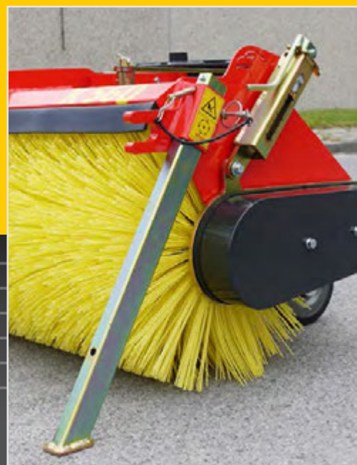
Großer Auswurfwinkel im Maschinenrahmen – ideal zum Schneekehren
