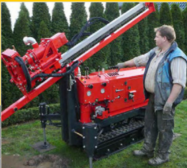
Per Hydraulik Abstellstützen ausfahren und Mast aufrichten.
