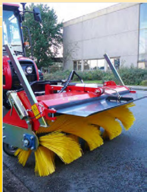
K 560 mit verstellbarem Spritzschutzblech
