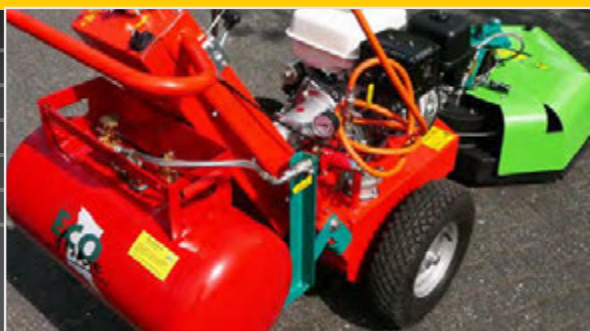
LPG-Gastank mit Schnellwechselrahmen
