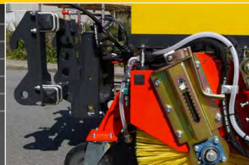
Radladeraufnahme mit Niveauegleich über Rollenführung
