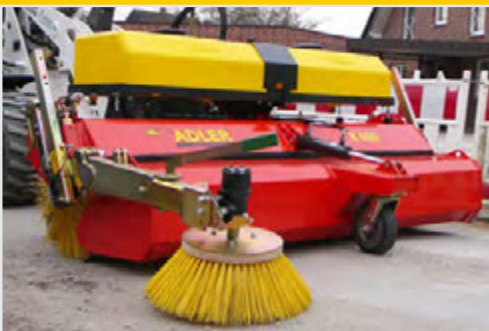
Seitenkehrbesen und Wassersprüheinrichtung als Option
