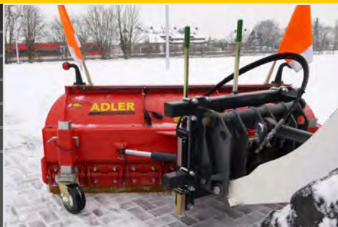
Universalaufnahme mit hydraulischer Verschwenkung (mit zwei Hydraulikzylindern)
