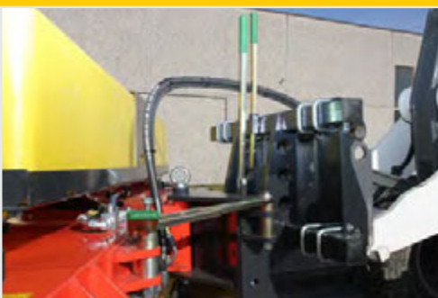
Rollenführung mit Niveaueingleich – beste Boden Anpassung in jedem Gelände
